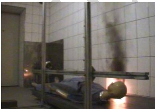
Brandversuch 12.05.2006 IdF. Hier gut sichtbar der senkrecht aufsteigende Qualm kurz nach der Zündung der Matratze. Der Kopf des Dummys daneben wird (noch) nicht tangiert.
