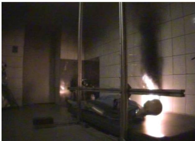
Gleicher Brandversuch. Versuchslaufzeit nach 2:01 Minuten. Eigenständiger Brand der Matratze ab 0:40 Sekunden. Verqualmung im Deckenbereich mithin bereits nach 1 Minute 21 Sek. deutlich sichtbar, eine Absenkung der Rauchsicht auf Kopfhöhe ist bis dahin nicht erfolgt, eine Ablagerung an den Wänden ist visuell noch nicht darstellbar. Der Alarm wurde in diesem Versuch nach 82 Sekunden ausgelöst.
